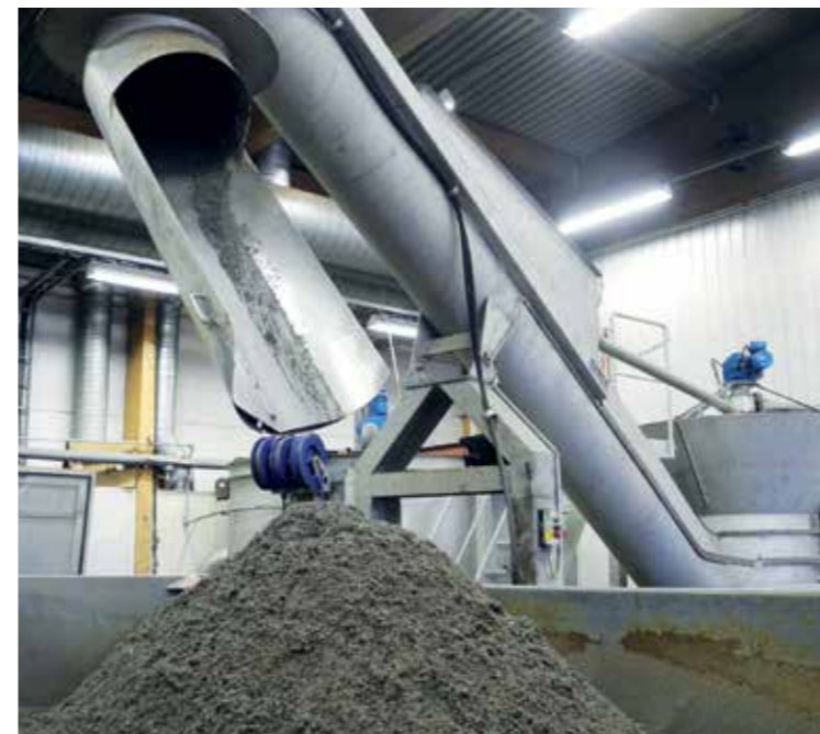
▲ Ekokem etsii jatkuvasti uusia hyötykäyttötapoja käsittelemilleen jätteille. Hiekanerotuskaivojätteiden käsittelystä syntyvää pestyä kiveä, hiekkaa ja pesulietettä on käytetty ympäristörakentamisessa.
